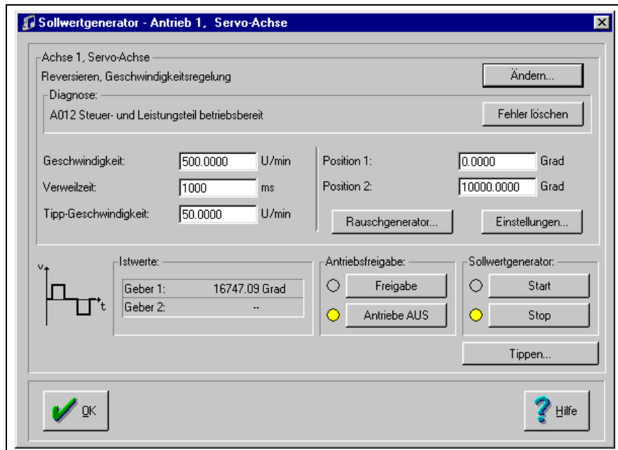
Abb. 5-11: Sollwertvorgaben für Antrieb 1, Servo-Achse.
