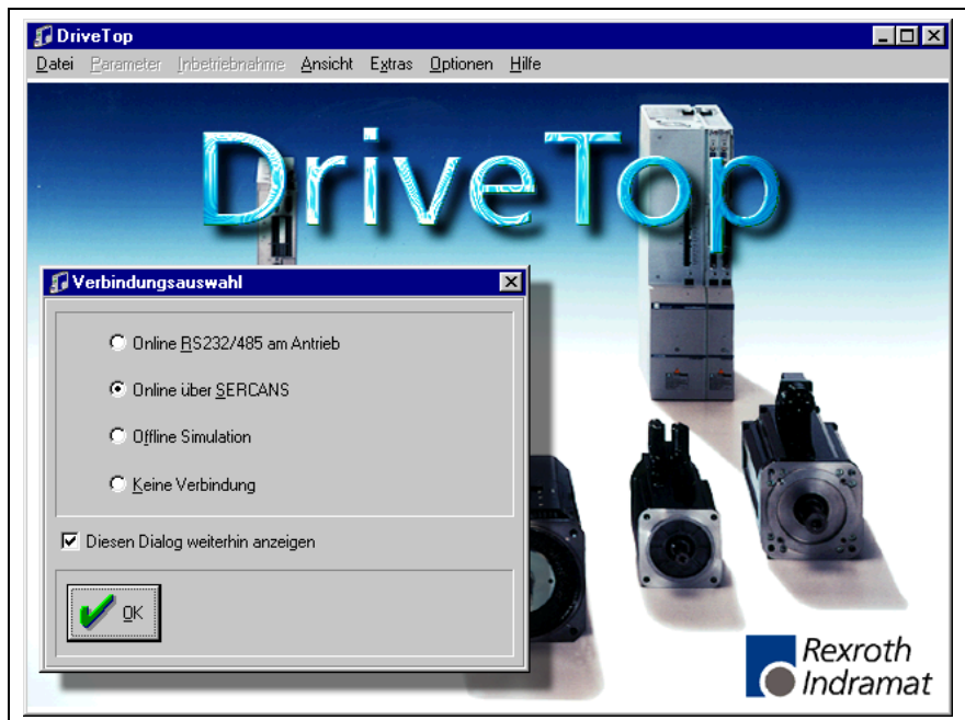
Abb. 5-7: Verbindungsaufbau. Auswahl „Online über SERCANS“.
